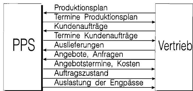
Abbildung 8.3: Koppelung von PPS und Vertrieb.
