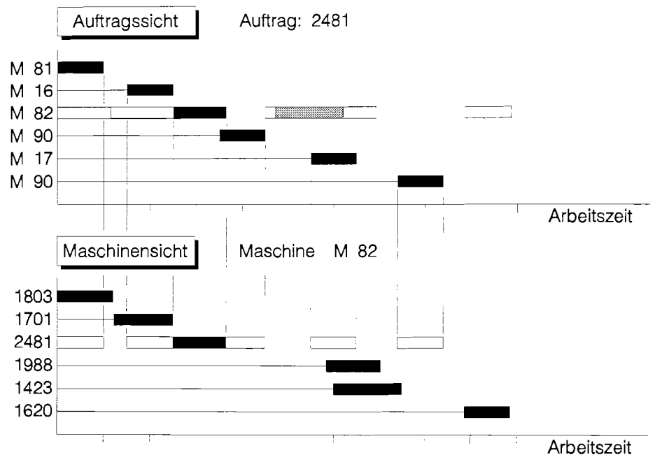
Abbildung 7.9: Die Auftragssicht zeigt einen Auftrag in seinem Ablauf über die Ressourcen, die Maschinensicht zeigt, welche Aufträge bei einer Ressource eingeplant sind.
